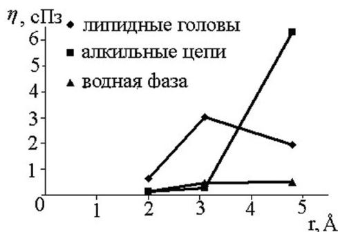
Рис. 5. Зависимость микровязкости от эффективного радиуса пробных молекул в системе ПОФХ-вода. Суммарная сила F_{\text{ext}} = 10 ккал/моль \cdot с ^{-1}
